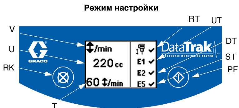
Рис. 5. Устройства управления модулем DataTrak и их индикаторы
